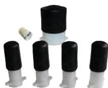
Ces kits sont utilisés pour isoler l'extrémité du câble principal. Ils assurent la classe II en étant constitués de 5 capuchons rétractables à froid (4 pour les conducteurs et 1 recouvrant l'ensemble pour réaliser la double isolation). Une bande de mastic permet de parfaire l'étanchéité.
