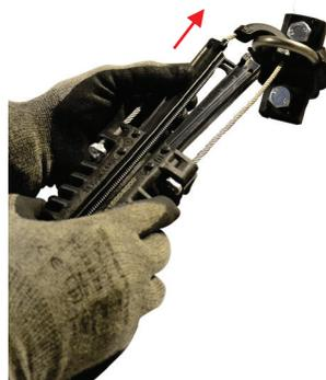
Ouvrir les coins en position ouverture maximale
