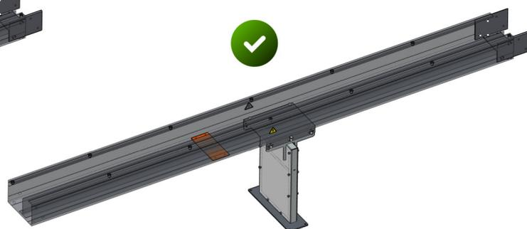
**10 b** Ajouter le séparateur sur l'éclisse de fond et le positionner de sorte à laisser 1/3 d'espace au PE, 2/3 au réseau.
