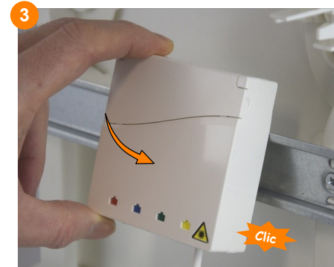
Clipper le DT10 sur le rail DIN dans le coffret. Le DT10 peut également se clipper avec les sorties orientées sur le côté.
