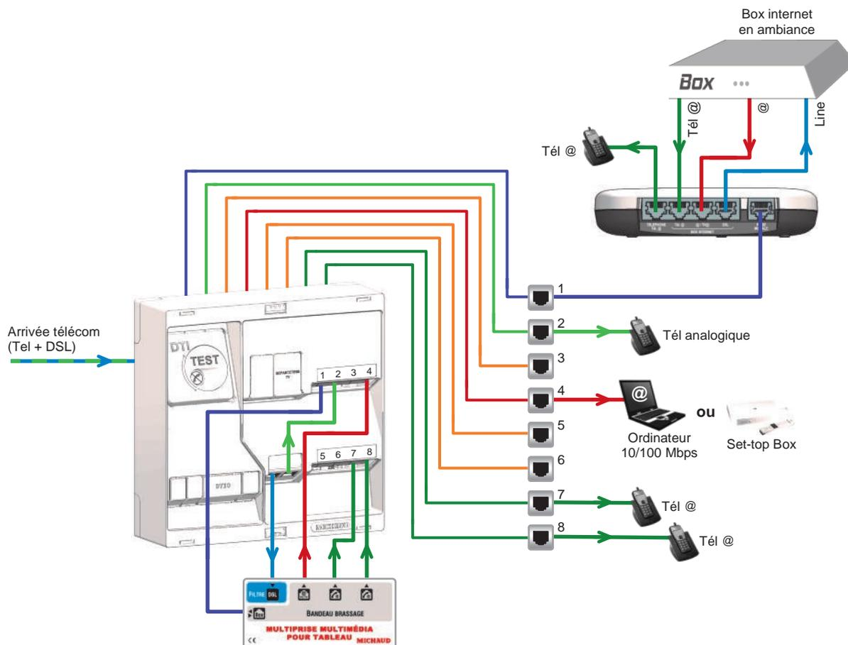
**NOTA :** L'installation d'un Switch type MICHAUD Q192 (vendu en accessoire) dans la zone attenante, connecté à la sortie PC/TV de la multiprise multimédia pour tableau, peut permettre de multiplier les départs Ethernet ou TV@.
