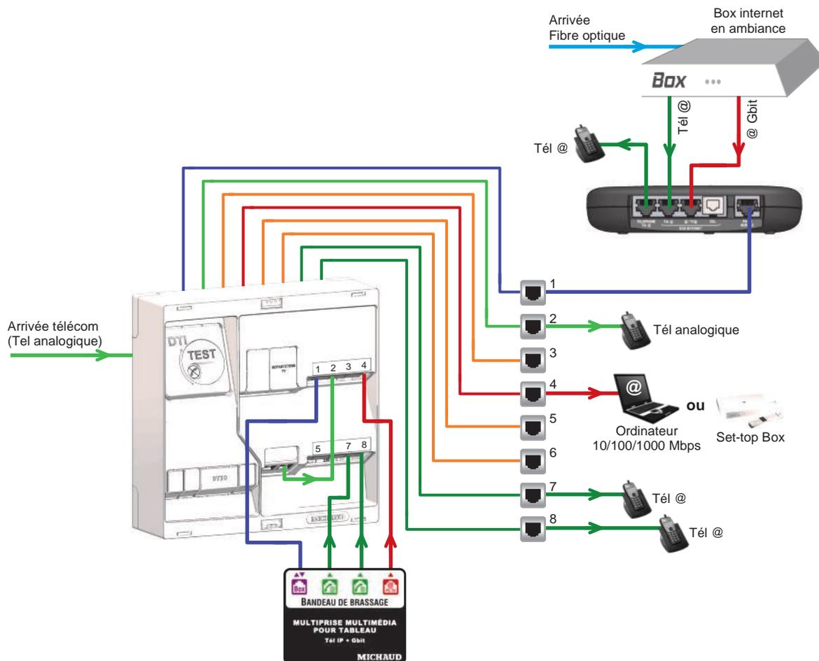
**NOTA :** L'installation d'un Switch type MICHAUD Q192 (vendu en accessoire) dans la zone attenante, connecté à la sortie PC/TV de la multiprise multimédia pour tableau, peut permettre de multiplier les départs Ethernet ou TV@.
