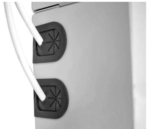
4.5 Couper un trou rond dans le passe-fil avec un diamètre plus petit que le câble entrant puis insérer le câble à travers le passe-fil. Fixer le câble sur la décharge de traction avec un collier en plastique.
