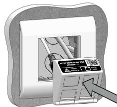
3 - Repousser l'ensemble avec précaution, sans coincer ou plier la fibre, et clipper l'enjoliveur sur le support.
