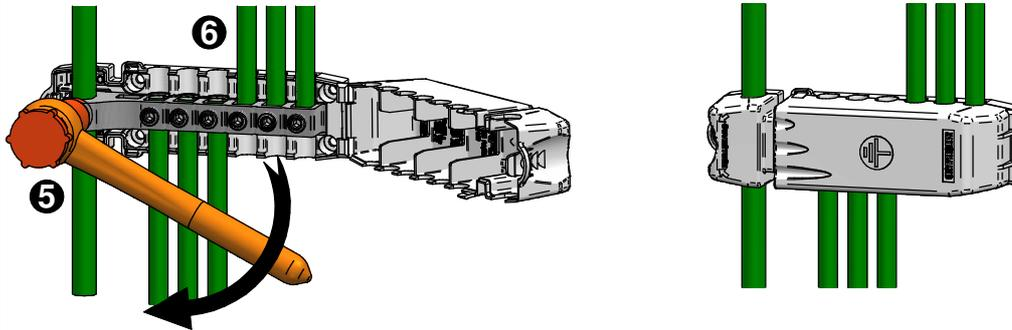
**5** Positionner le conducteur de protection principal et serrer la vis avec une clé H10 jusqu'à rupture de la tête fusible.
