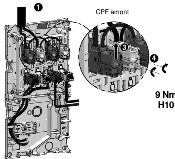
Note : Pour faciliter le raccordement des CPF amont, ces derniers sont déclippable si nécessaire
